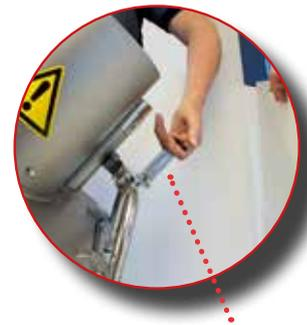
Der Einfüllzylinder wird mit der Anti-Tipping-Protection fixiert. Der Benutzer muss den Sicherheitshebel ziehen, um den Einfüllzylinder abzusenken.
