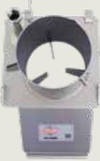
Einfüllzylinder A mit 3 internen Messern fixiert und trennt die Produkte während des Schneidvorganges. Der Einfüllzylinder A kann mit der pneumatischen Einfüllvorrichtung, der manuellen Einfüllvorrichtung und der 4-Rohr-Füllvorrichtung verwendet werden. Er ist besonders für die Verarbeitung von Kohl oder anderen großen Gemüsen geeignet.
